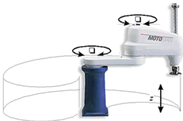
ภาพที่ 2.1 แขนกลสเกล่า (Scalar Robot)
