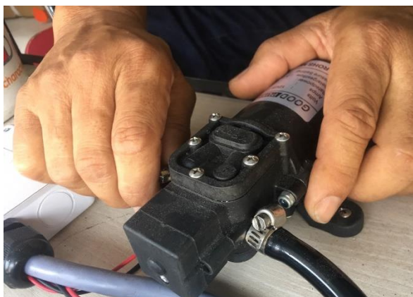
ภาพที่ 3.19 การต่อสปริงเกอร์เข้ากับปั้มน้ำแรงดันสูง
