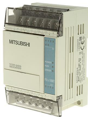
ภาพที่ 3.12 PLC Mitsubishi รุ่น Fx1s
