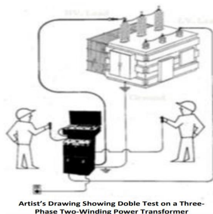
ภาพที่ 2.25 วงจรวัดค่าสภาพของฉนวน (%PF)
