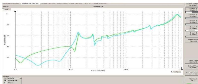
ภาพที่ 2.35 การตอบสนองความถี่ของหม้อแปลงก่อนการบำรุงรักษา
