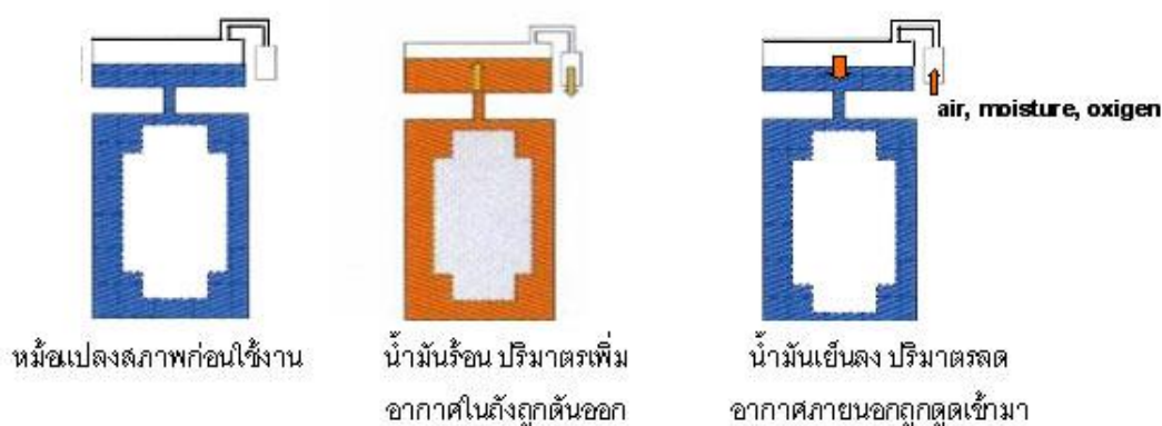
ภาพที่ 2.16 สภาพของการใช้งานหม้อแปลงแบบมีถังพัก
