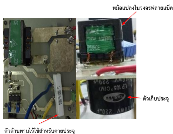
ภาพที่ 3.12 วงจรฟลายแบ็คคอนเวอร์เตอร์ของเครื่องลดความชื้น
