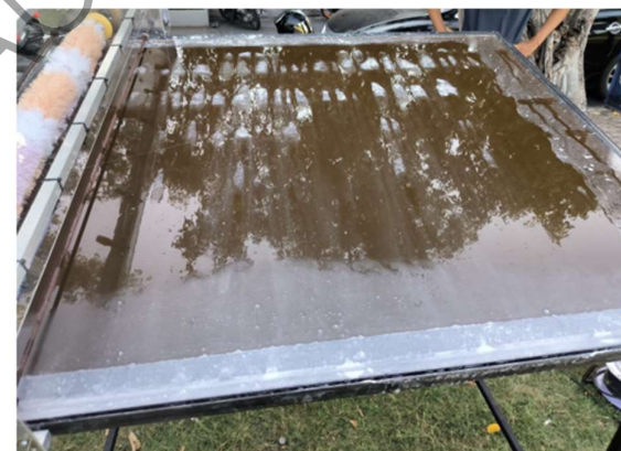
รูปที่ 19 ผลการล้างแผงโซลาร์เซลล์ด้วยระบบควบคุมด้วยตนเอง
